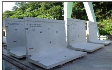
製品養生状況
